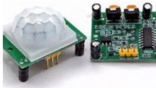
Рисунок 3 - Інфрачервоний датчик Arduino HC-SR501
