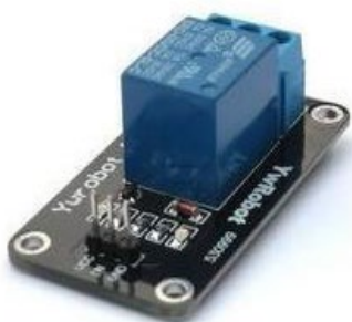
Рисунок 2 - Електромагнітне реле SRD- 05VDC -SL - C
