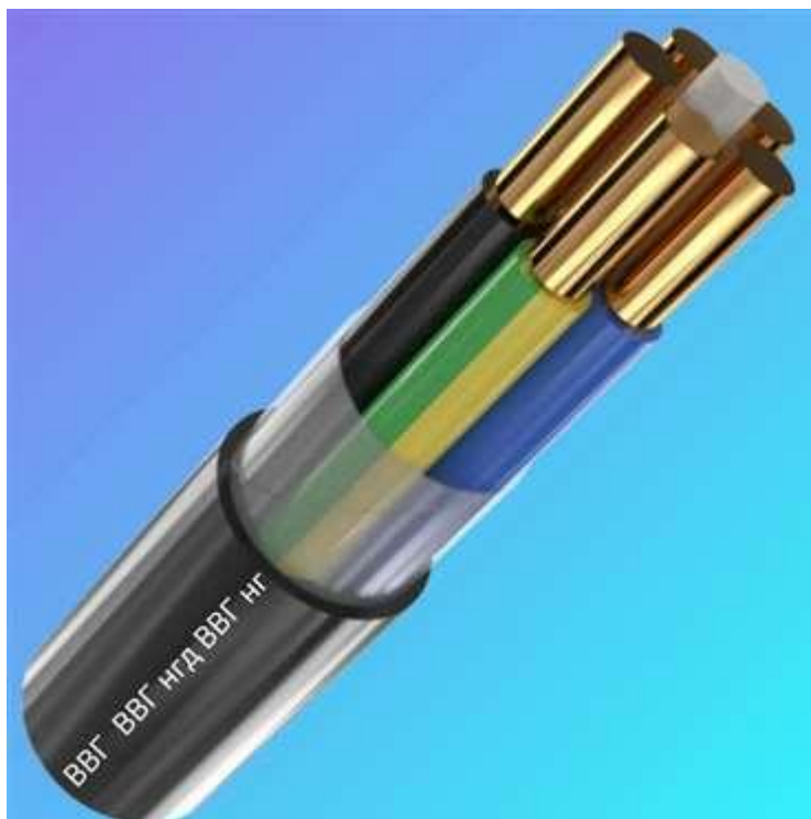
Рисунок 2.18 – Розріз багатожильного кабелю ВВГ 4×25
