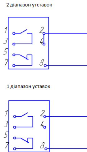
Рисунок. 1.6 - Схема внутрішніх з'єднань реле напруги [4]
