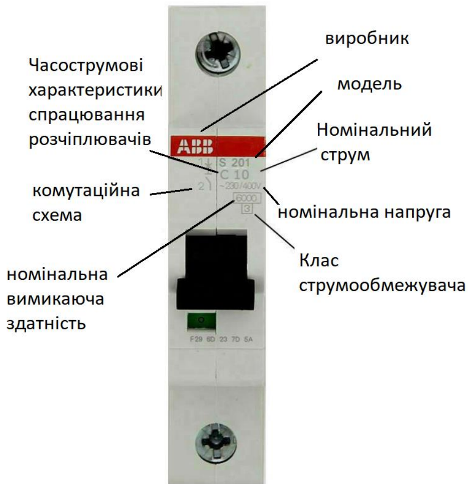
Рисунок 2.9 - Позначення маркування на АВ
