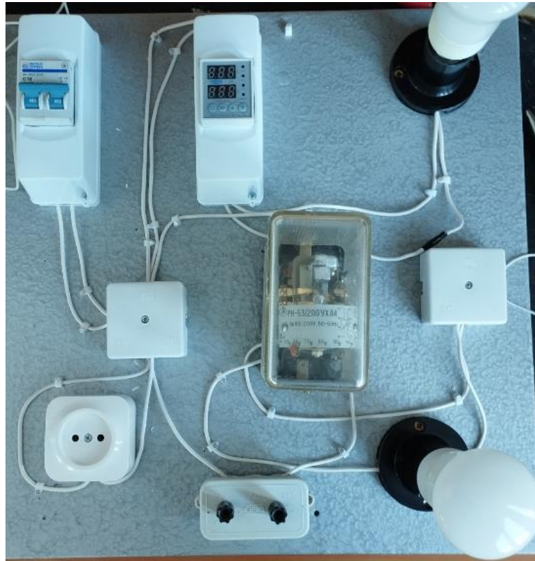
Рисунок 3.4 - Загальний вигляд схеми з реле контролю напруги
