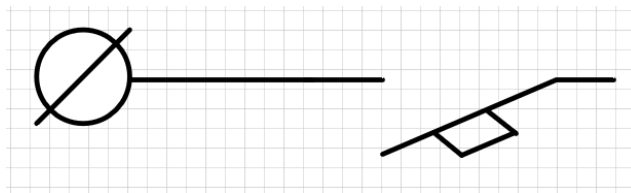
Рисунок 2.10 - підключення автоматичного вимикача
