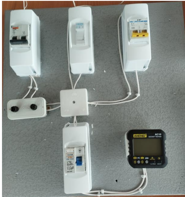
Рисунок 3.6 – Загальний вигляд схеми з ПЗВ, запобіжником та автоматом
