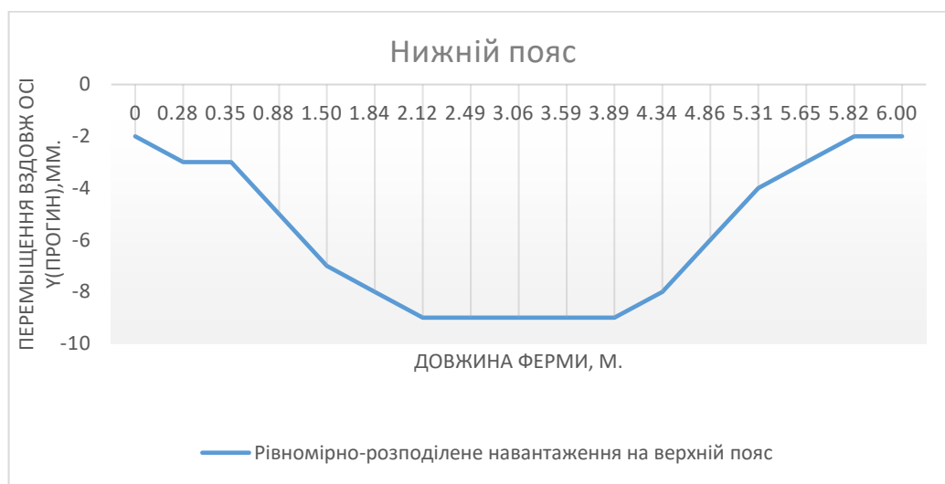
Рисунок 3.7 – Переміщення точок нижнього поясу вздовж осі Y
