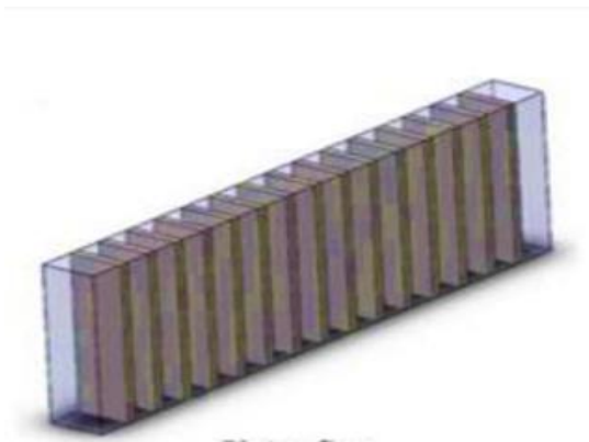
Рис. 1.14. Тепловий акумулятор з пластинчастими теплообмінними ребрами.
