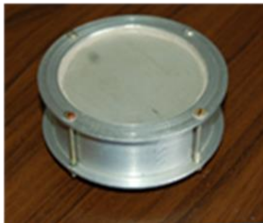
Рис.3.3. Зовнішній вигляд акумулятора тепла для стабілізації температурного режиму світлодіодних матриць.
