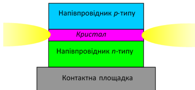
Рис. 3.11. Схематична будова світлодіодного елемента.
