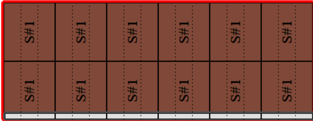
Рисунок 2.12 - Випадок 1.4 (один ряд комірок у 6 модулях затінений)
