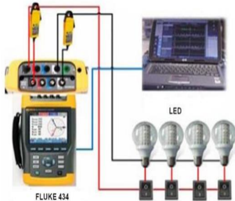
Рисунок 2.4 - Схема підключення FLUKE 434 до мережі живлення СДсвітильників
