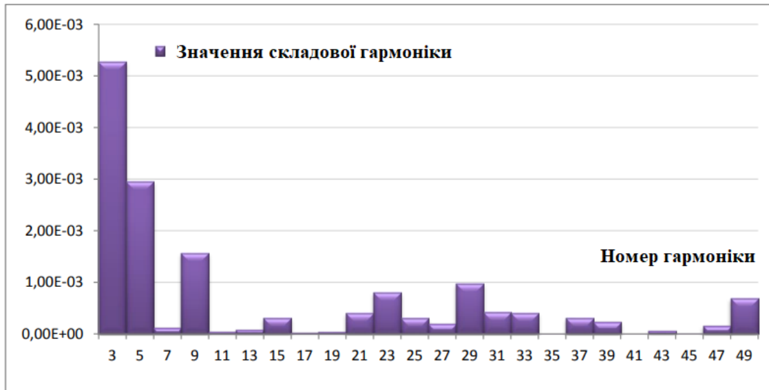
Рисунок 2.7 - Спектральний склад гармонік за струмом у мережі живлення на одному світильнику
