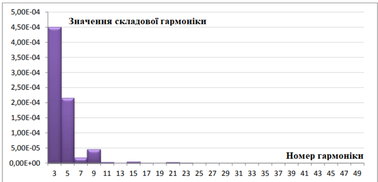
Рисунок 2.6 - Спектральний склад гармонік за напругою в мережі живлення на одному світильнику
