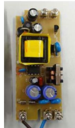
Рисунок 1.5 - Світлодіодні лампи і схема драйвера а) світлодіодні лампи; б) Схема СД-драйвера світильника
