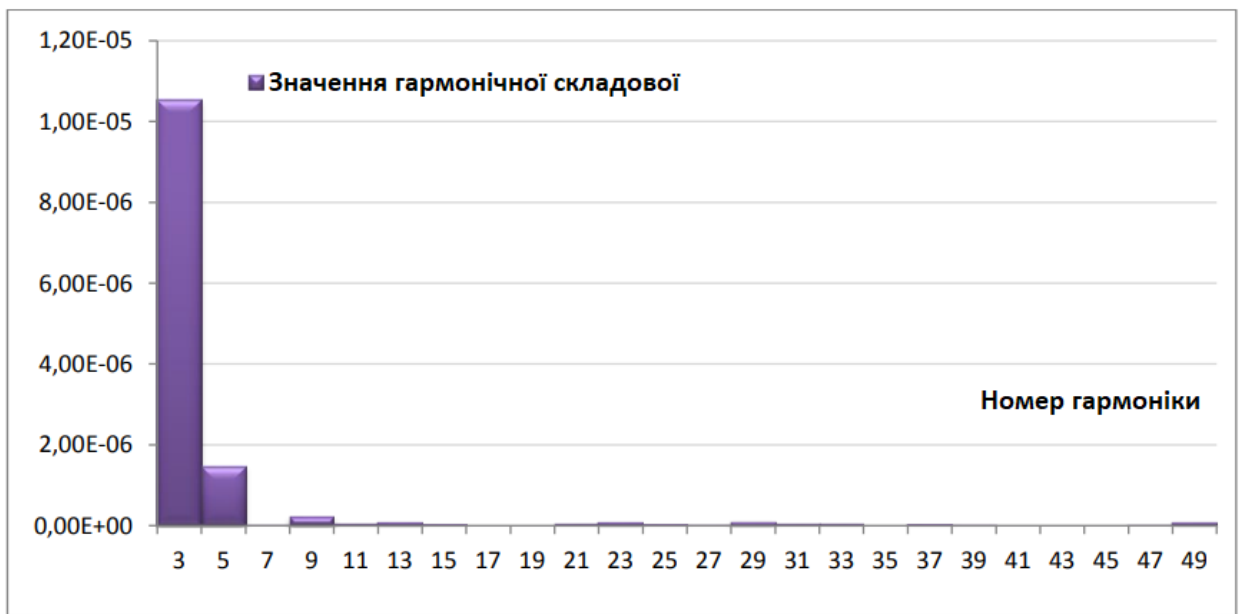
Рисунок 3.2 - Спектральний склад гармонік за струмом у мережі живлення на одному світильнику після встановлення ФКП
