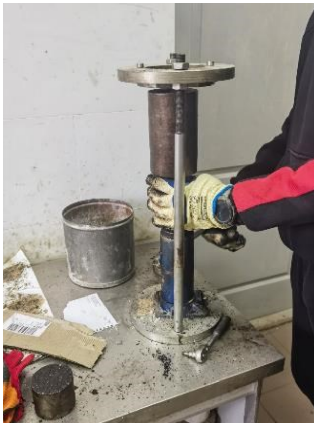
Рисунок 3.12 – Виймання зразку за допомогою витискного пристрою
