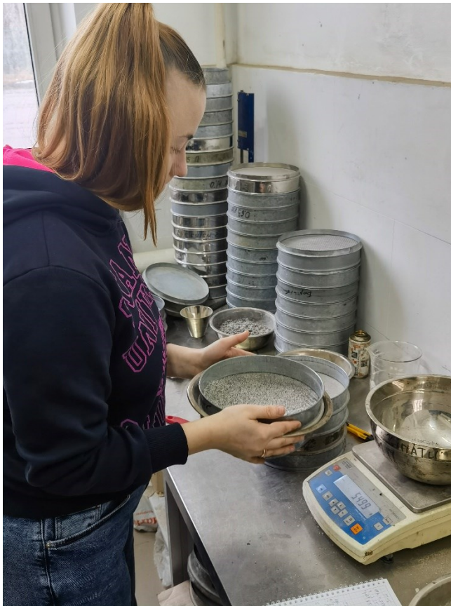
Рисунок 3.7 – Просіювання (а) та зважування (б) матеріалів
