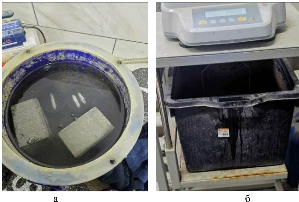
Рисунок 4.1 – Визначення середньої густини асфальтобетону
