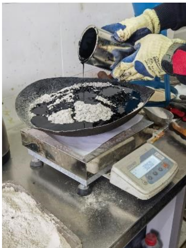
Рисунок 3.10 – Дозування (а) та замішування (б) матеріалів
