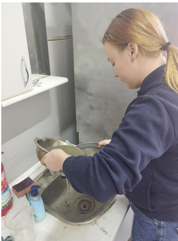
Рисунок 3.4 – Фільтрування каламутної води через сито 0,071 мм
