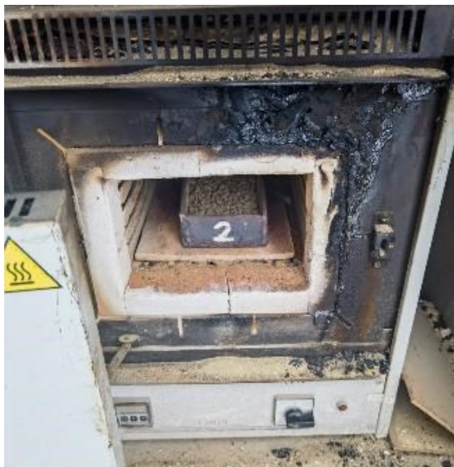
Рисунок 3.6 – Випалювання бітуму у муфельній печі
