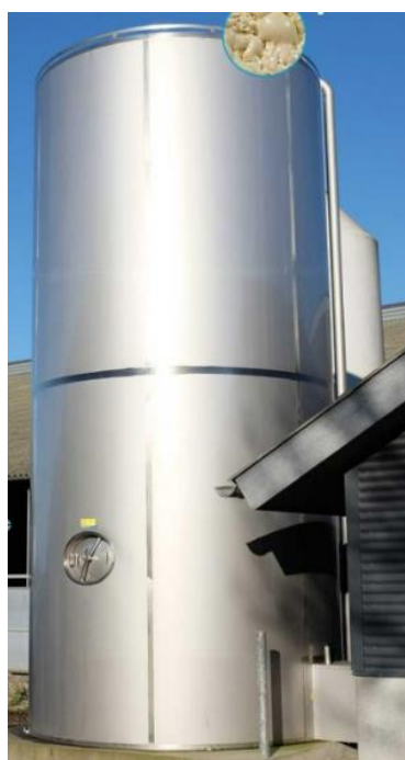
Рисунок 1.7 - Резервуар для зберігання молока РОКА 5000
