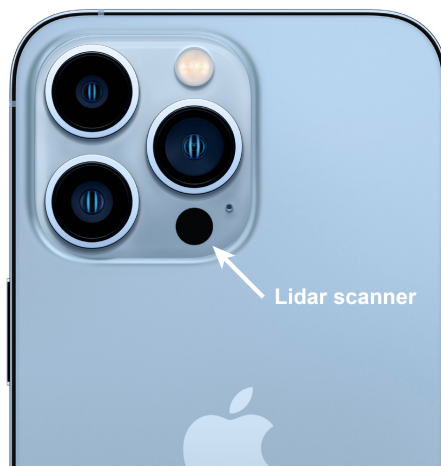
Рисунок 2.10 - Вигляд сканера в корпусі iPhone 13Pro
