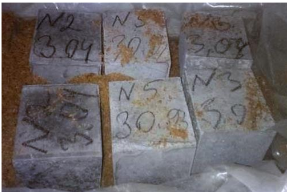
Рисунок 2.3 - Зберігання зразків для визначення міцності у віці 28 діб для застосування в монолітному житловому будівництві
