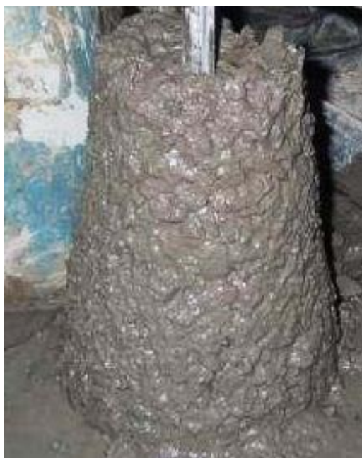
Рисунок 2.2 - Вивчення рухливості бетонної суміші за усадкою конуса
