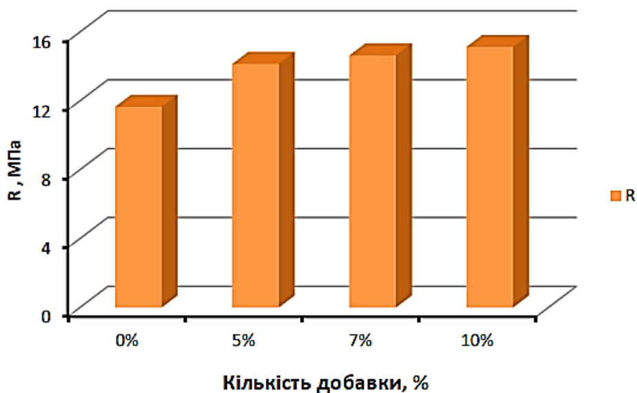
Рисунок 2.8 - Діаграма зміни міцності при стисненні залежно від кількості введеної добавки
