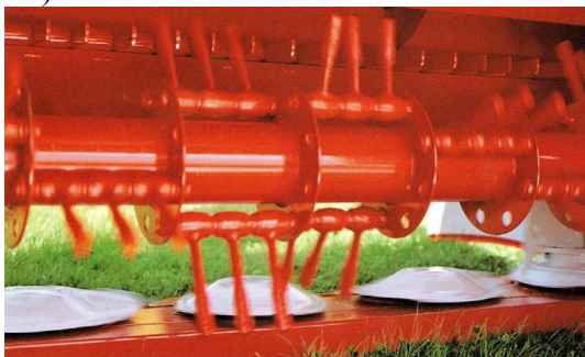
Рис. 3. Плющильний апарат динамічної дії косарки FC 303GC, Kunh
