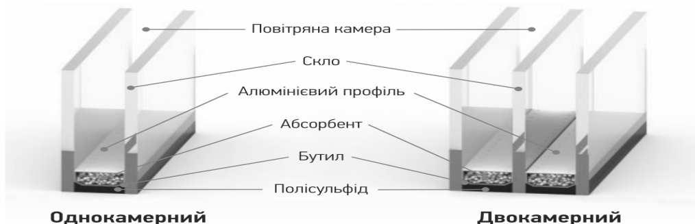
Рисунок 1. Конструкція однокамерного та двокамерного склопакету
