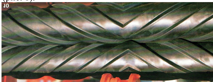
Рис. 1. Спіральні плющильні вальці косарки FC 202R фірми Kuhn та Disco 3000 TRC фірми Claas.
