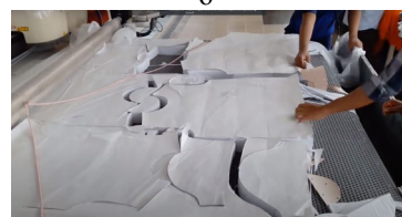
Рис. 1. Конвеєрні системи для текстильного виробництва: (а) конвеєрна система лазерної порізки; (б) фрикційні елементи конвеєрної системи для порізки лезом; (в) приклад людської праці для маніпулювання текстильних матеріалів під час руху конвеєрної системи.
