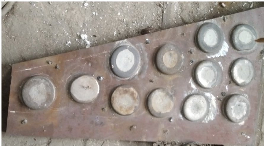
Рис. 1 Наплавлена футеровка щоквої дробарки
