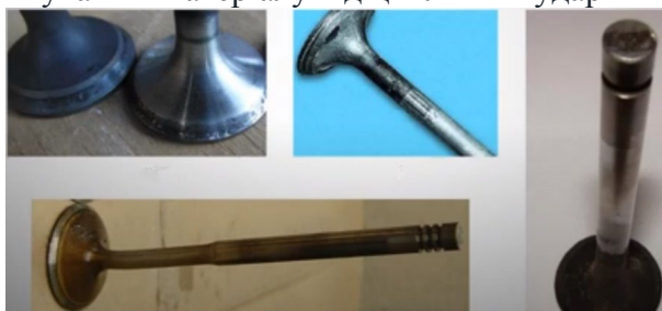
Рисунок 1 – Дефекти клапанів двигунів внутрішнього згорання.
