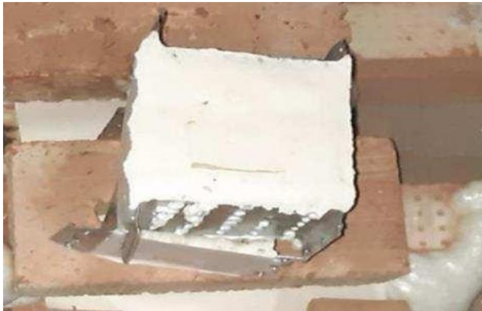
Рисунок 2.1 - Куби 10x10x10 см з пінополіуретану, прикріпленого до сталевого листа
