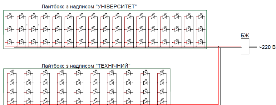
Рисунок 3.10 – Схема живлення світлодіодів в лайтбоксах
