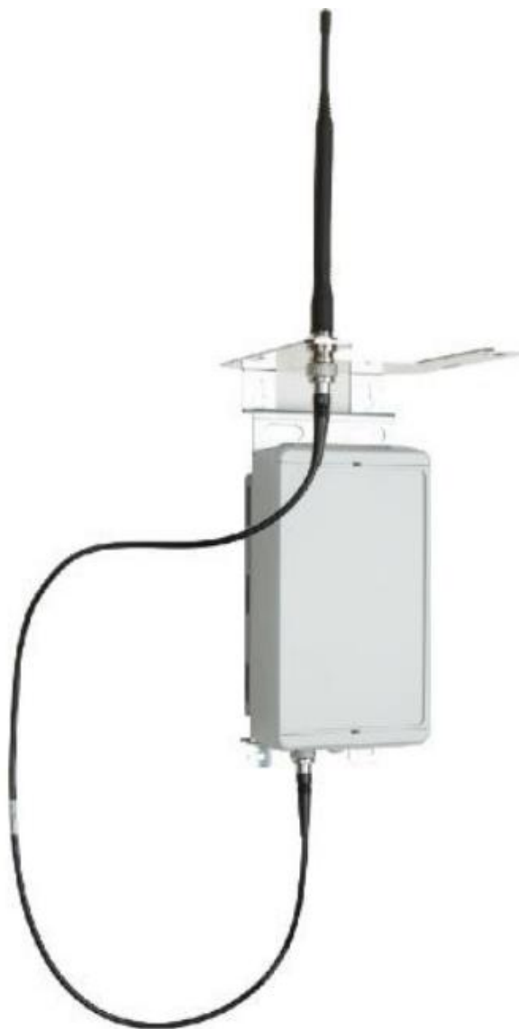
Рисунок 3.12. Шлюз керування контролерами
