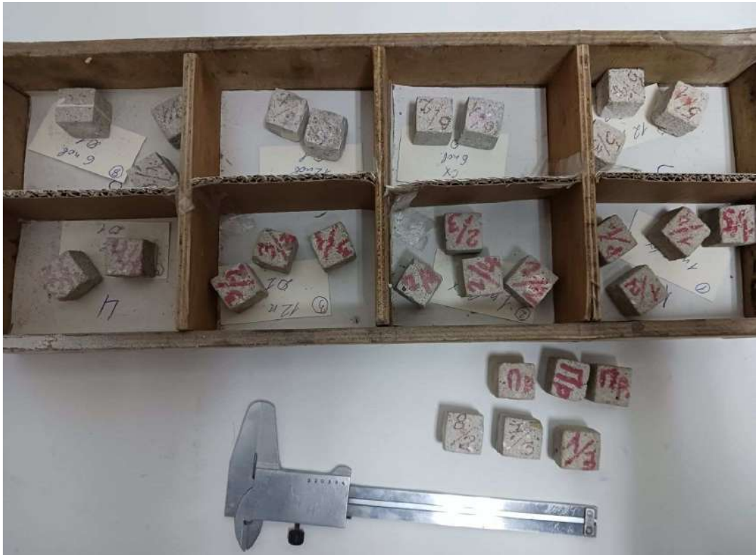
Рисунок 3.21 – Випробувальні зразки розчину відібраного із швів цегляної кладки
