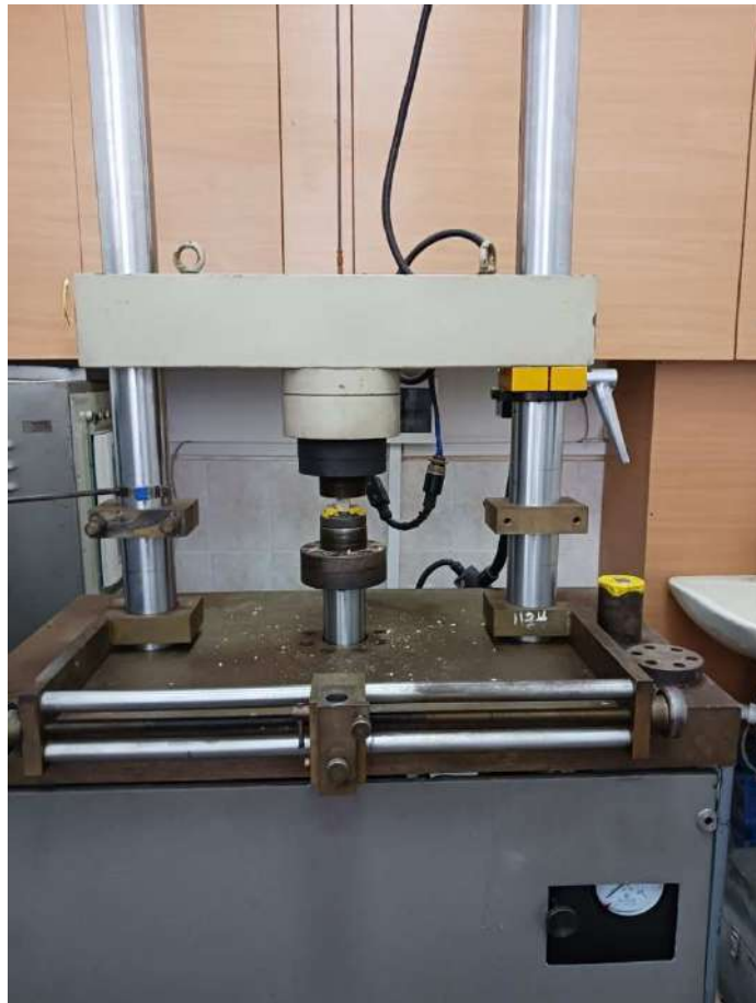
Рисунок 3.22 – Процес випробування зразків розчину відібраного із швів цегляної кладки
