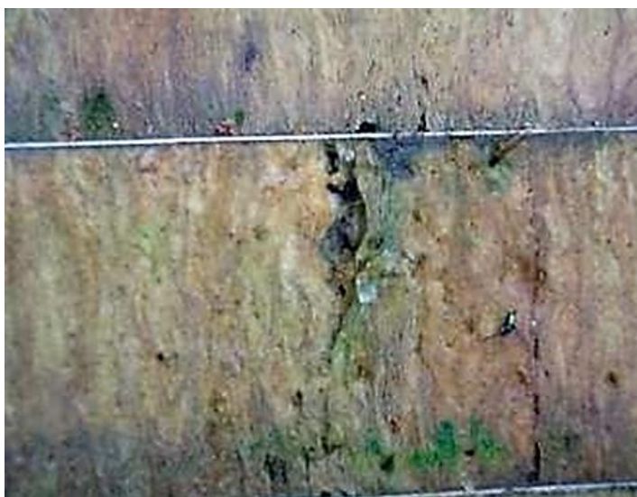
Рисунок 1.24 - Вигляд утеплювача неналежного зберігання
