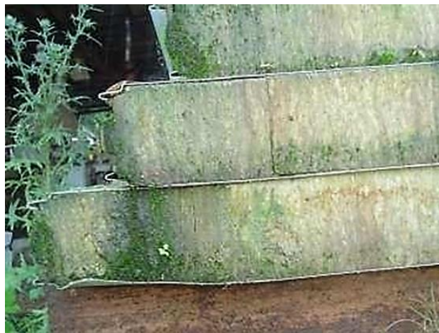
Рисунок 1.26- Вигляд утеплювача після тривалого зберігання за атмосферних опадів
