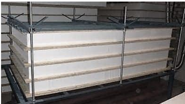
Рисунок 1.11 - Витримка сендвіч-панелі під пресом
