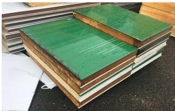
Рисунок 1.21 - Порушення складування сендвіч-панелей під час атмосферних опадів (дощ)
