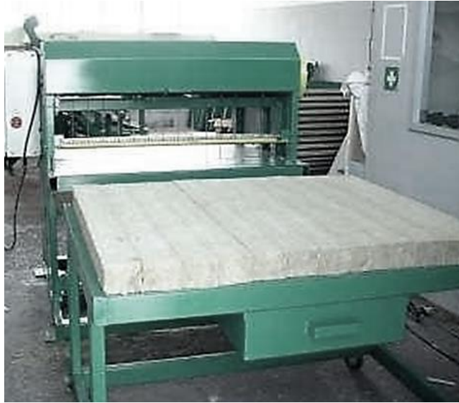
Рисунок 1.9 - Укладання ламелей у плиту
