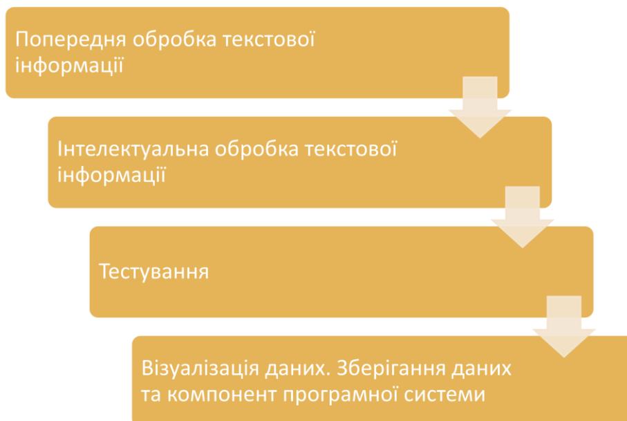
Рис.1 – Програмний конвеєр для класифікації текстової інформації
