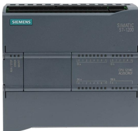
Рисунок 2.3 – Програмований логічний контролер S7–1200
