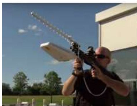
Рисунок 4. DroneDefender в двох конфігураціях від компанії Battelle
