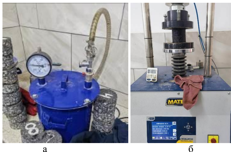
Рис. 2 – Установка для визначення водонасичення асфальтобетонної суміш (а), межі міцності на стиск (б)
