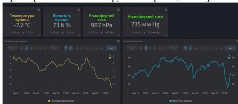
Рис. 3 - Вікно програми на мобільному пристрої для керування параметрами мікроклімату у виробничому приміщенні при складанні приладів
