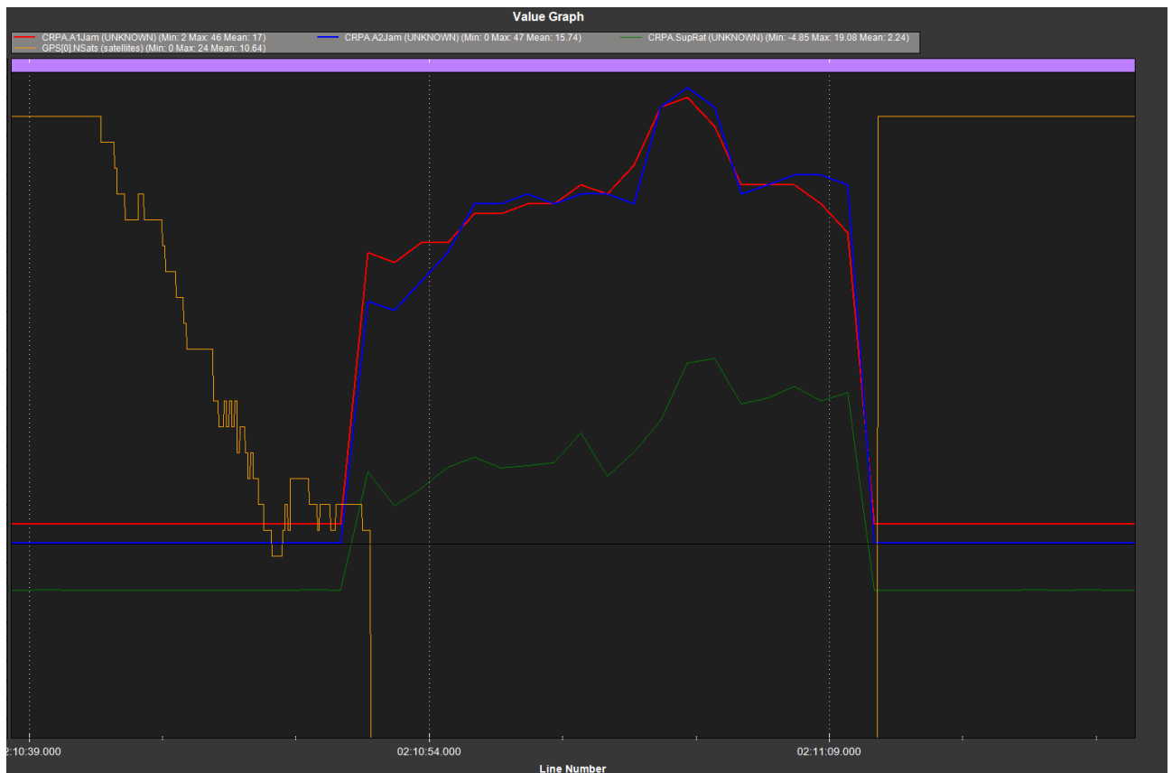
Рис 2.7 Графік реакції системи безпілотного апарату на відсутність сигналів системи супутникової навігації. Один проміжок.
