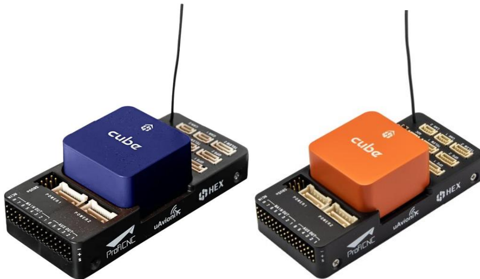
Рис 2.3 Контролери Pixhawk версії Blue і Orange CUBE. Ці версії однакові за характеристиками та функціональністю але виготовленні в різних країнах.[12],[13]
