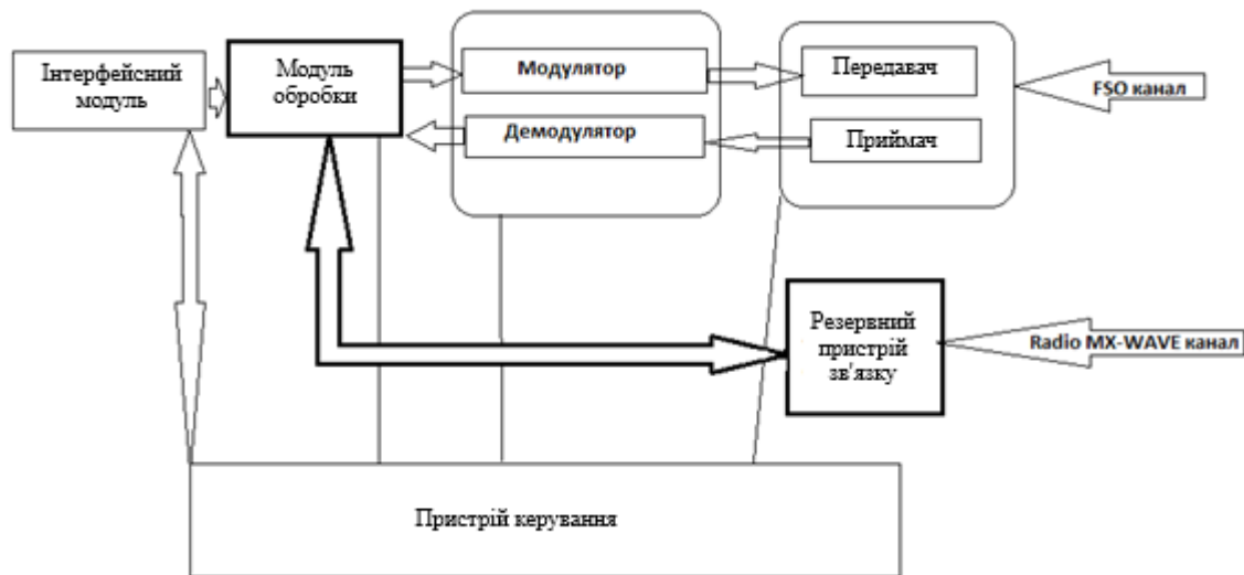
Рис. 3.3. Загальна схема FSO термінального пристрою.
