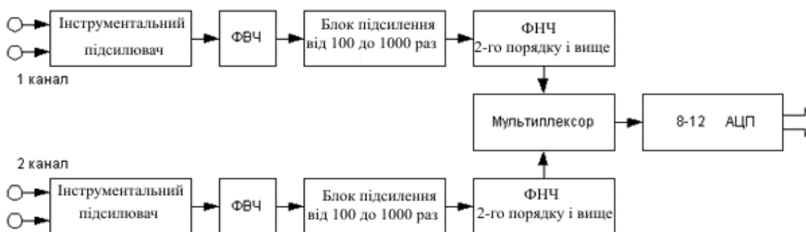
Рисунок 1.2 – Структурна схема аналогового блоку стандартного ДМ ЕКГ
