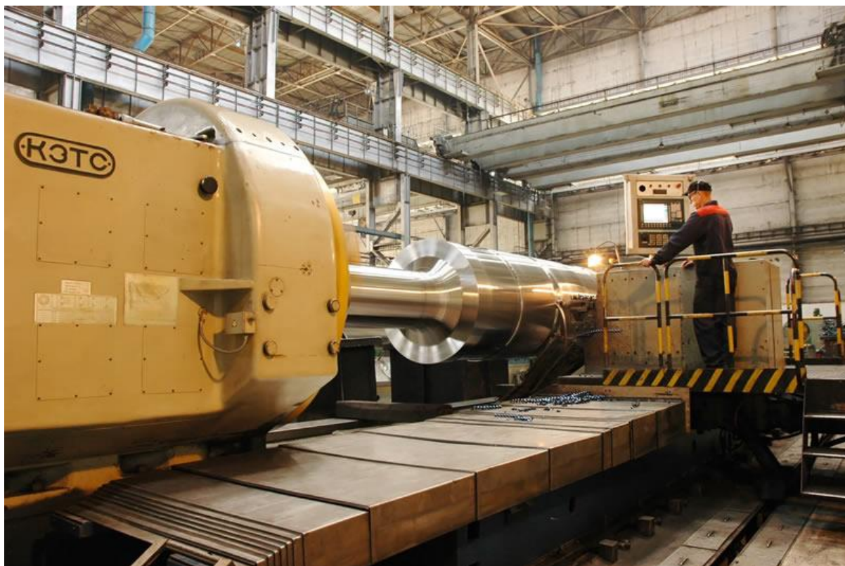
Рисунок 1.3 - Токарний верстат 1К670Φ3.
