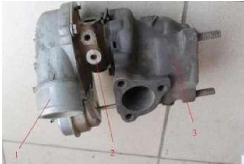
Рис.1.9. Турбокомпресор Garrett GT2049S для двигуна 2.0 TDI "DuraTorq" Ford Transit V :
