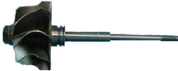
Рис. 1.2. Зовнішній вигляд роторного валу турбонагнітача від Garrett, модель GT2049S, призначений для мотору 2.0 TDI DuraTorq, що встановлюється в автомобілі Ford Transit V.
