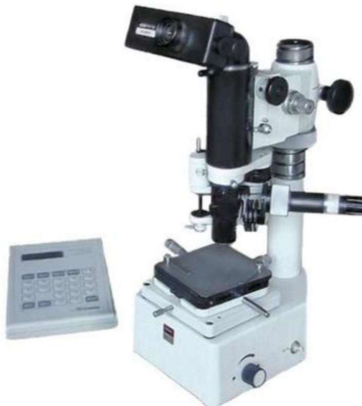
Рис. 2.7. Вид приладу для вимірювання мікротвердості ПМТ-3.
