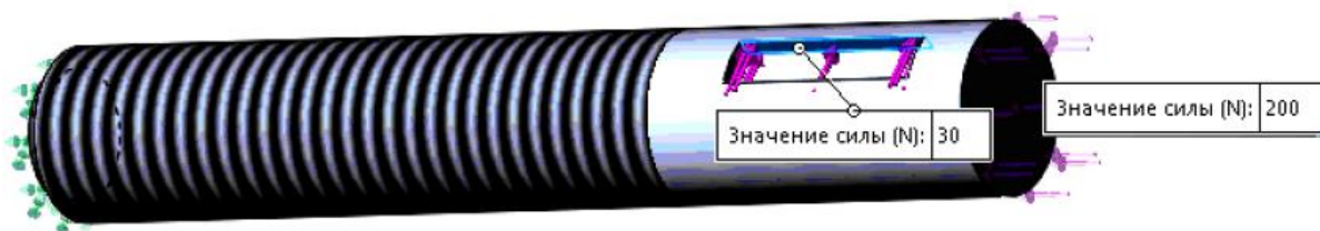
Рис. 4.9. Зовнішні ваги на кріпильний болт станда.
