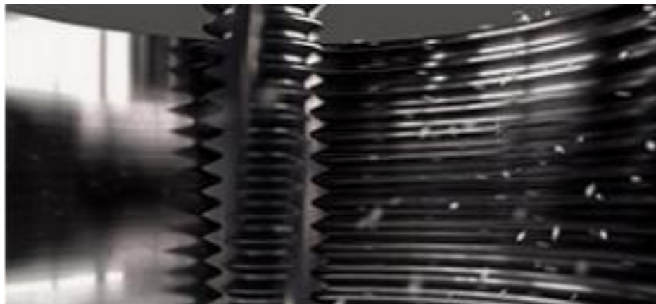
Рисунок 1.1 - Процес нарізання різьби на внутрішній циліндричній поверхні фрезою [12]
