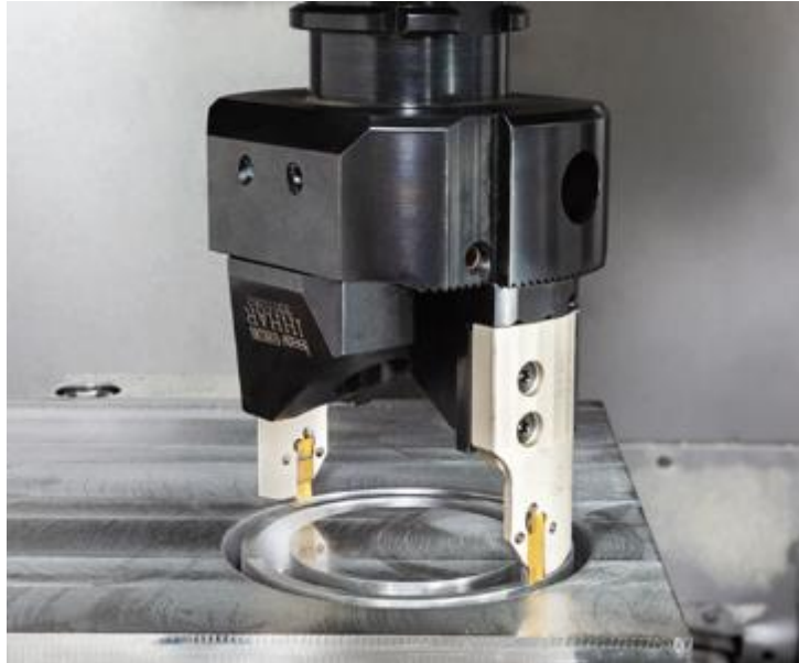
Рисунок 1.10 – Модульна система компанії ISCAR для нарізання торцевих канавок та вирізання отворів [25]
