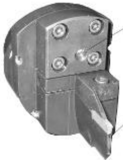
Рисунок 1.6 – Спеціальний інструмент із двома соплами для нарізання торцевих канавок з подачею охолоджуючої рідини під високим тиском [22]
