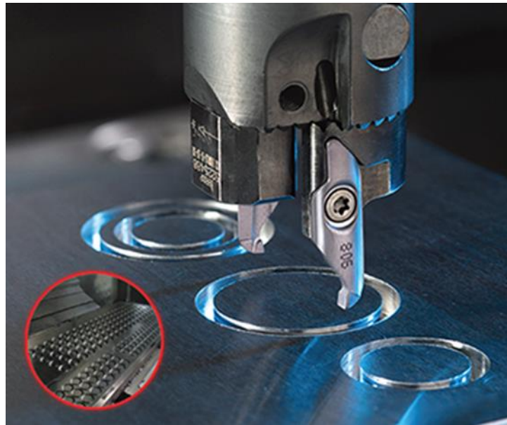
Рисунок 1.8 – Процес нарізання торцевих канавок інструментом компанії ISCAR [25]
