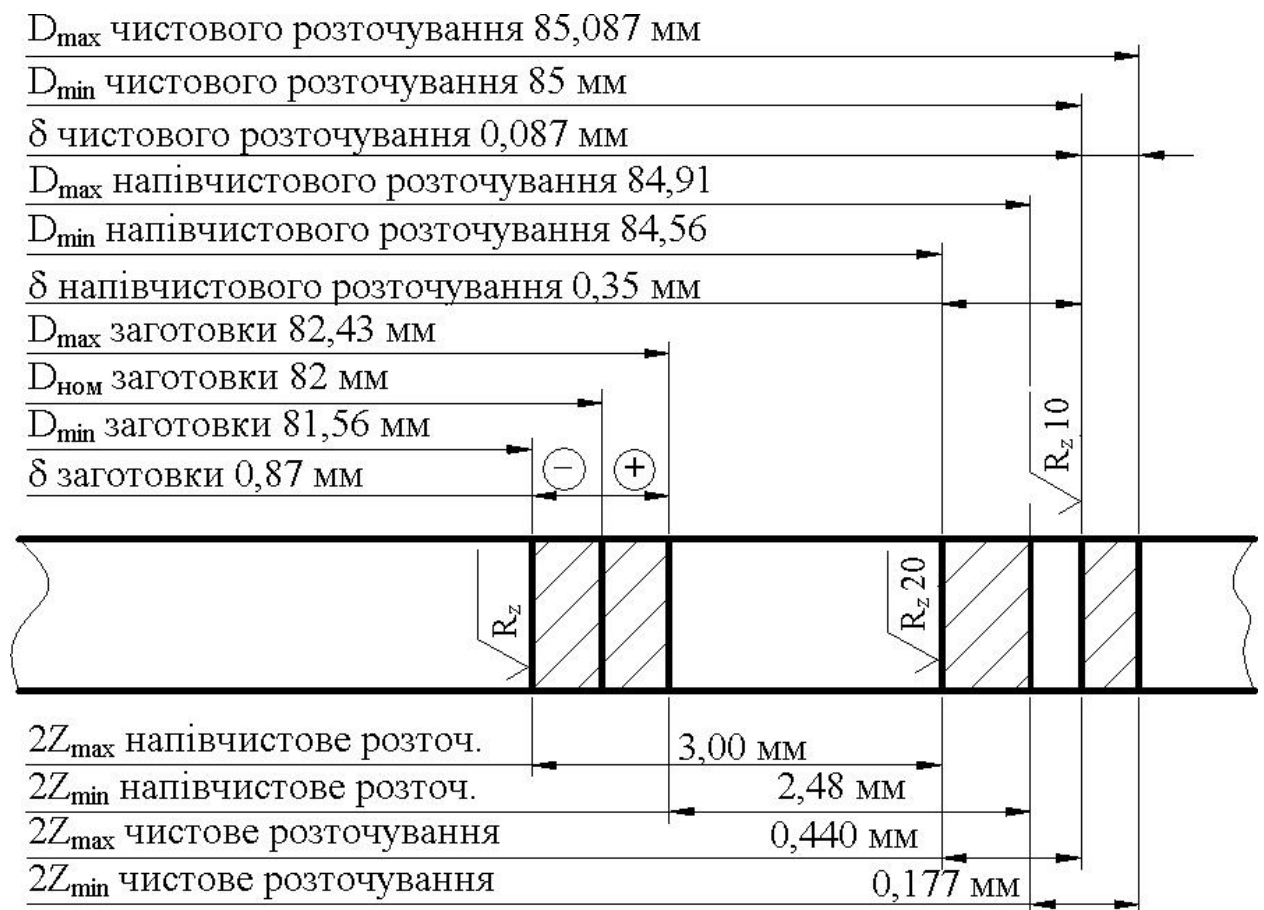
Рисунок 3.3 – Схема розташування припусків та допусків для поверхні \varnothing 85H9
