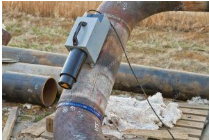
Рисунок 2.3 – Метод виїзного радіографічного контролю
