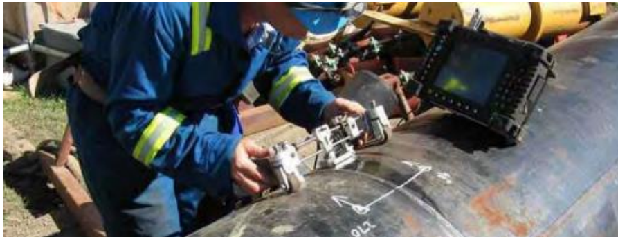
Рисунок 4.7 – Процес контролю зварного з'єднання
