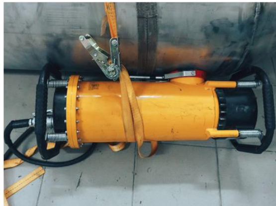
Рисунок 2.2 – Метод радіографічного контролю
