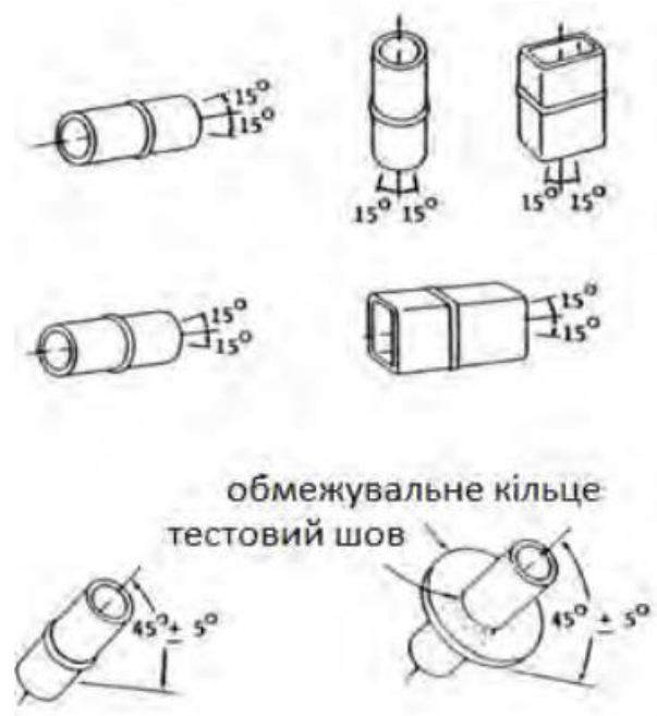
Рисунок 4.3 – Ілюстрації позицій зварювання труб
