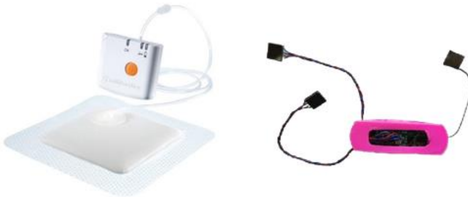
Рис. 3.2. Вакуумний пластир (лівий малюнок) та прототип пристрою (правий малюнок).
