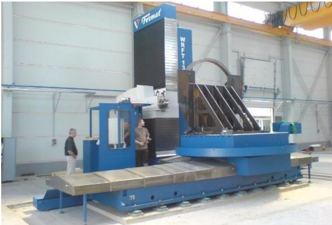
Рисунок 1.5 - Обробка косозубого сектора великого модуля на верстаті серії WRFT 130 / 150 / 160/ 200 CNC
