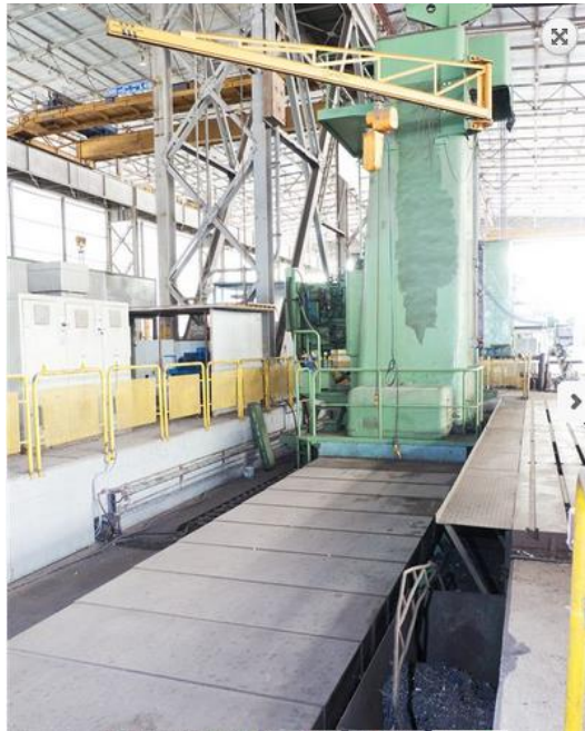
Рисунок 1.9 – Переміщення колони по станині
