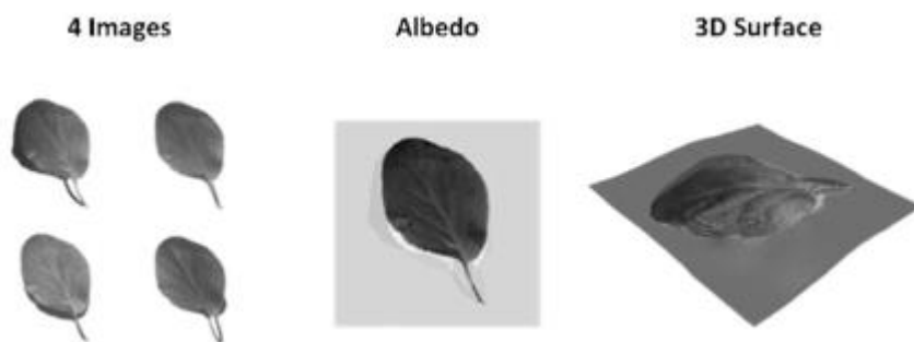
Рисунок 2.3 - Чотири зображення, отримані з використанням різних джерел освітлення, зображення альбеда та 3D-реконструкція (Джерело: Smith et al. [45])
