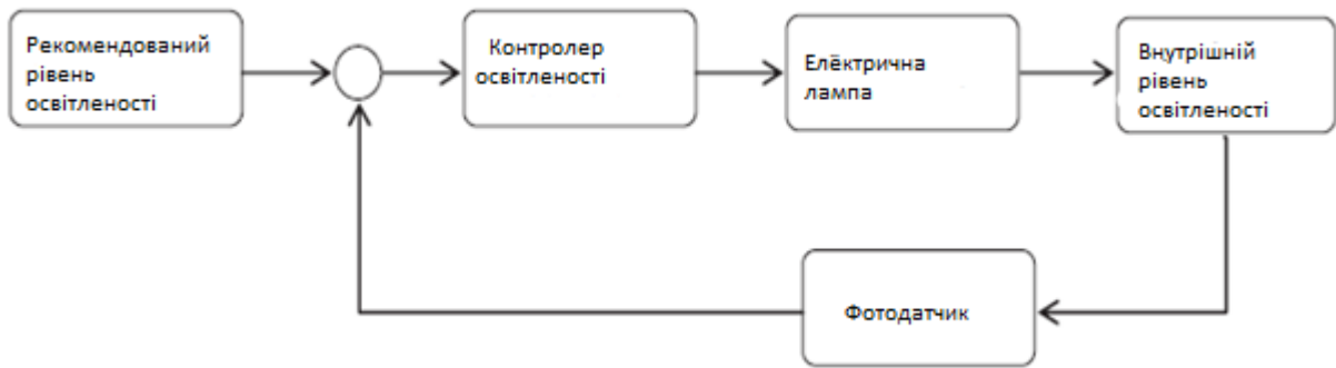
Рисунок 2.5 – Схема замкнутого циклу системи з природнім освітленням
