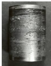
Рисунок 2. Поверхня сталюого контртіла після 1,5 годин випробувань з фторопластовою втулкою, з 70 мас. % Pb (спікання в середовищі дисоційованого аміаку)
