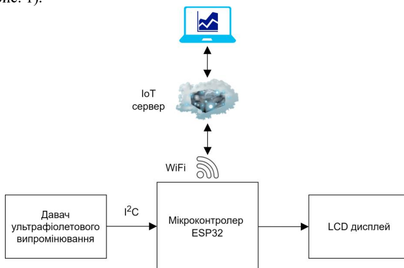
Рисунок 1. Структура системи дистанційного контролю інтенсивності УФ випромінювання
