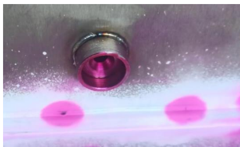
Рисунок 1. Кольорова дефектоскопія тонкостінної зварної конструкції
