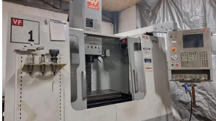
Рисунок 1. Металообробний центр HAAS VF-1 (США), на якому буде встановлено дослідну установку
