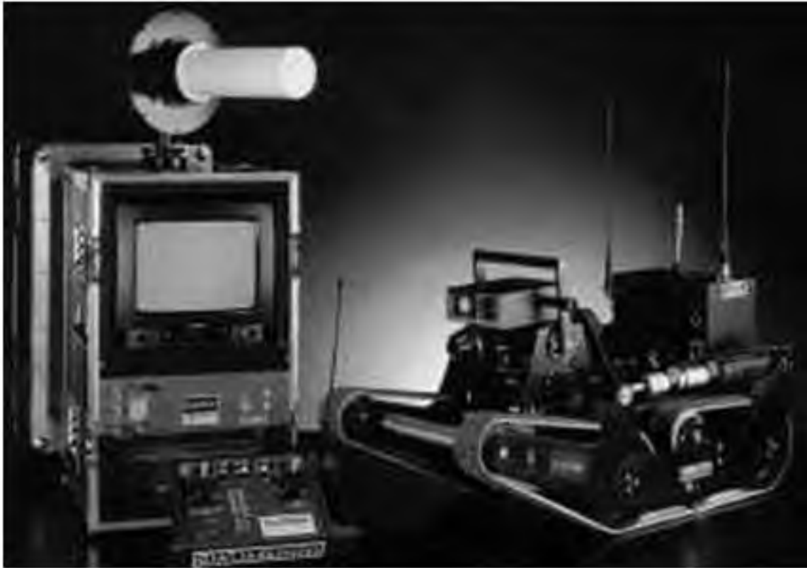
Рисунок 6.6 - Мобільний робот Castor (GIAT Industries, Франція) може мати або колісну, або гусеничну ходову частину
