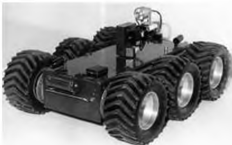
Рисунок 6.3 - Надлегкий мобільний робот МРК-01 (МГТУ ім. Н.Е. Баумана).
