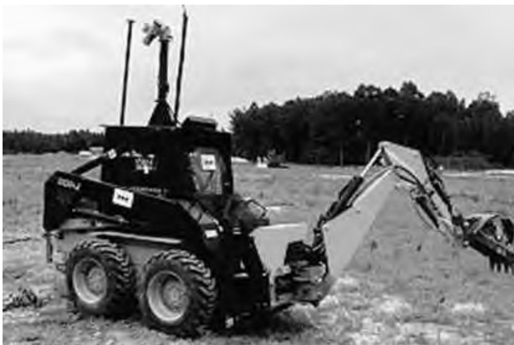
Рисунок 6.5 - Транспортний засіб роботизованої системи розмінування ETODS (ОАО, США) виконано на базі навантажувача типу "Bobcat"
