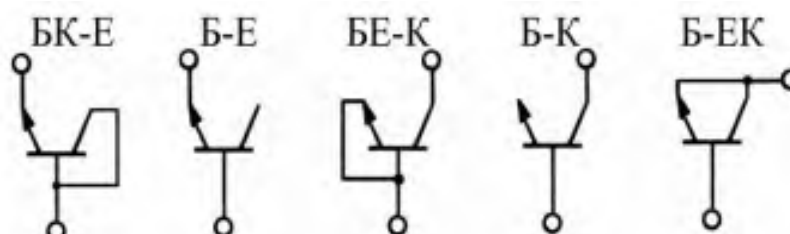
Рисунок 4.3 - Варіанти використання транзисторів у діодному ввімкненні
