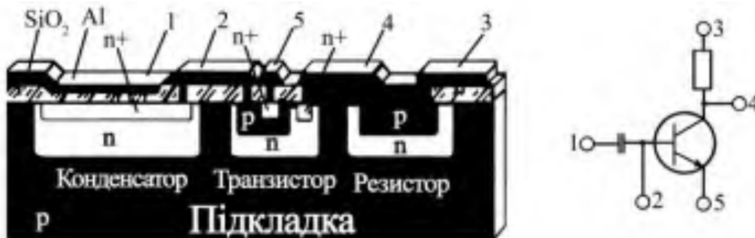
Рисунок 3.2 - Структура та електрична схема планарно- дифузійної НІМС
