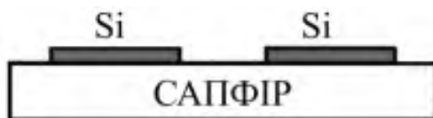
Рисунок 3.7 - Ізоляція типу «кремній на сапфірі»
