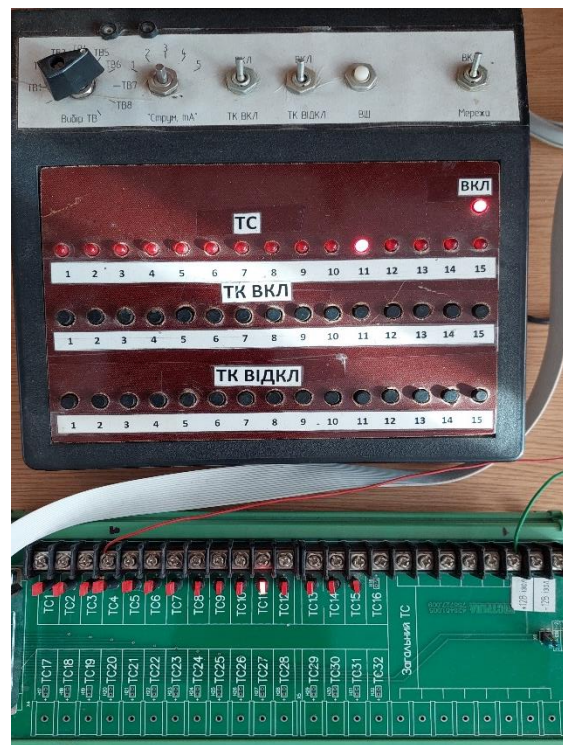
Рисунок 12 – Емулятор трансформаторної підстанції
