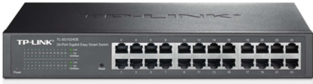
Рисунок 2.3. - Комутатор робочої групи мережі гімназії TP-Link TL-SG1024DE
