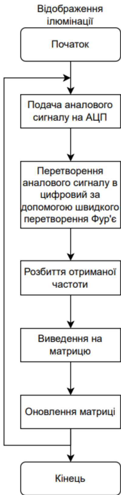
Рисунок 2.10 – Блок-схема алгоритму відображення ілюмінації
