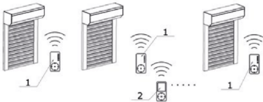
Рисунок 1.5 – Схема автоматики для управління групою ролет до 15 шт. на основі електродвигунів з вбудованим радіомодулем
