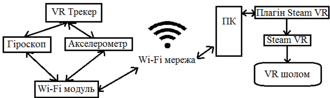
Рисунок 2.1 – Структура системи захоплення рухів в VR
