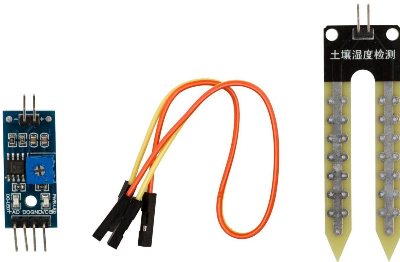
Рисунок 2.8 – Зовнішній вигляд давача вологості ґрунту FC-28
