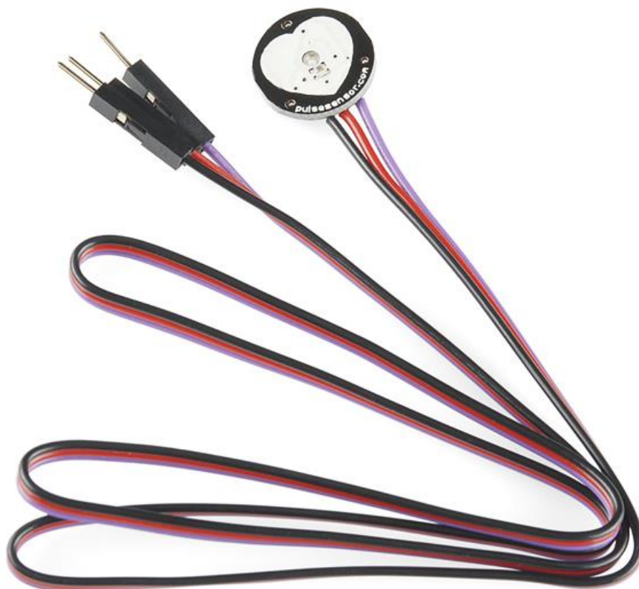
Рисунок 2.8 – Давач серцевого ритму SEN-11574
