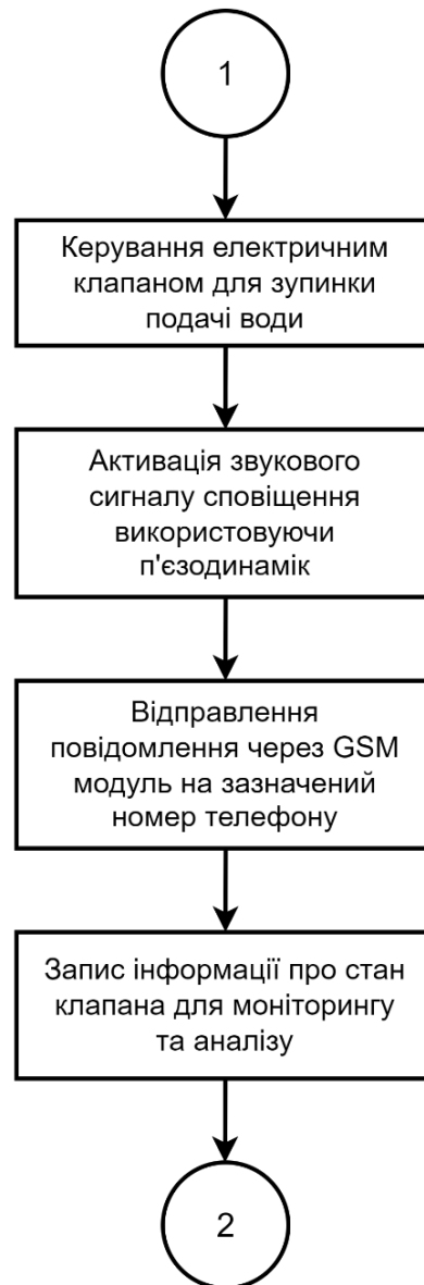
Рисунок 3.2 – Блок-схема алгоритму роботи ПЗ для мікроконтролера СКПВ (продовження)
