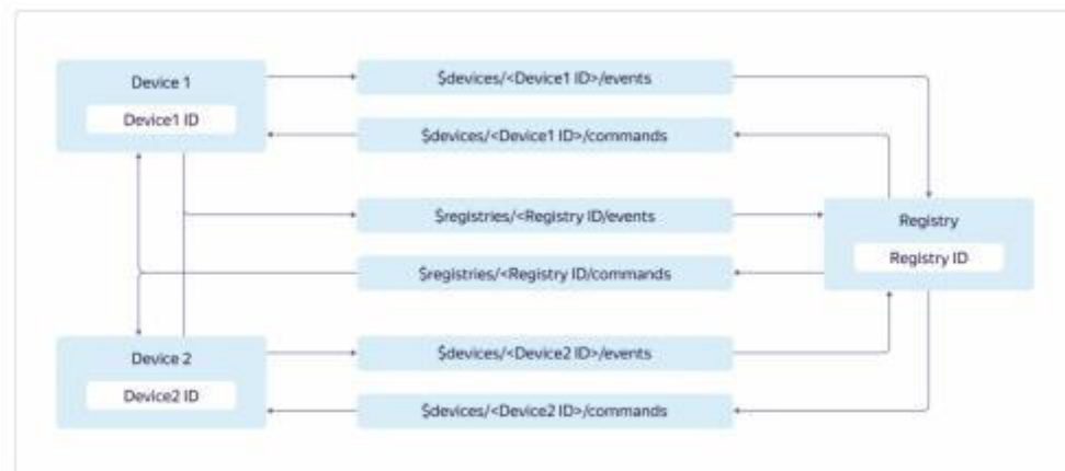
Рисунок 3.2 – Доступ пристроїв до MQTT -топиків в IoT Core
