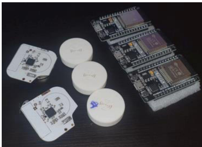
Рисунок 3.3 – Фото МК ESP32 та iBeacon Bluetooth маячків
