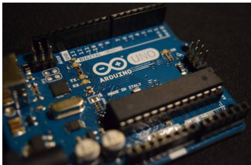
Рисунок 2.7 – Плата відлагодження на МК AVR
