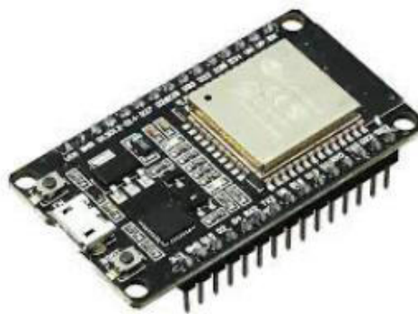
Рисунок 2.6 – Приклад модуля ESP32 DevKit v1
