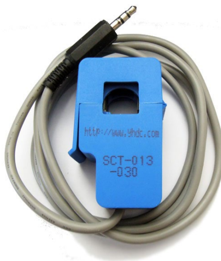
Рисунок 2.1 – Неінвазивний датчик змінного струму SCT-013-030
